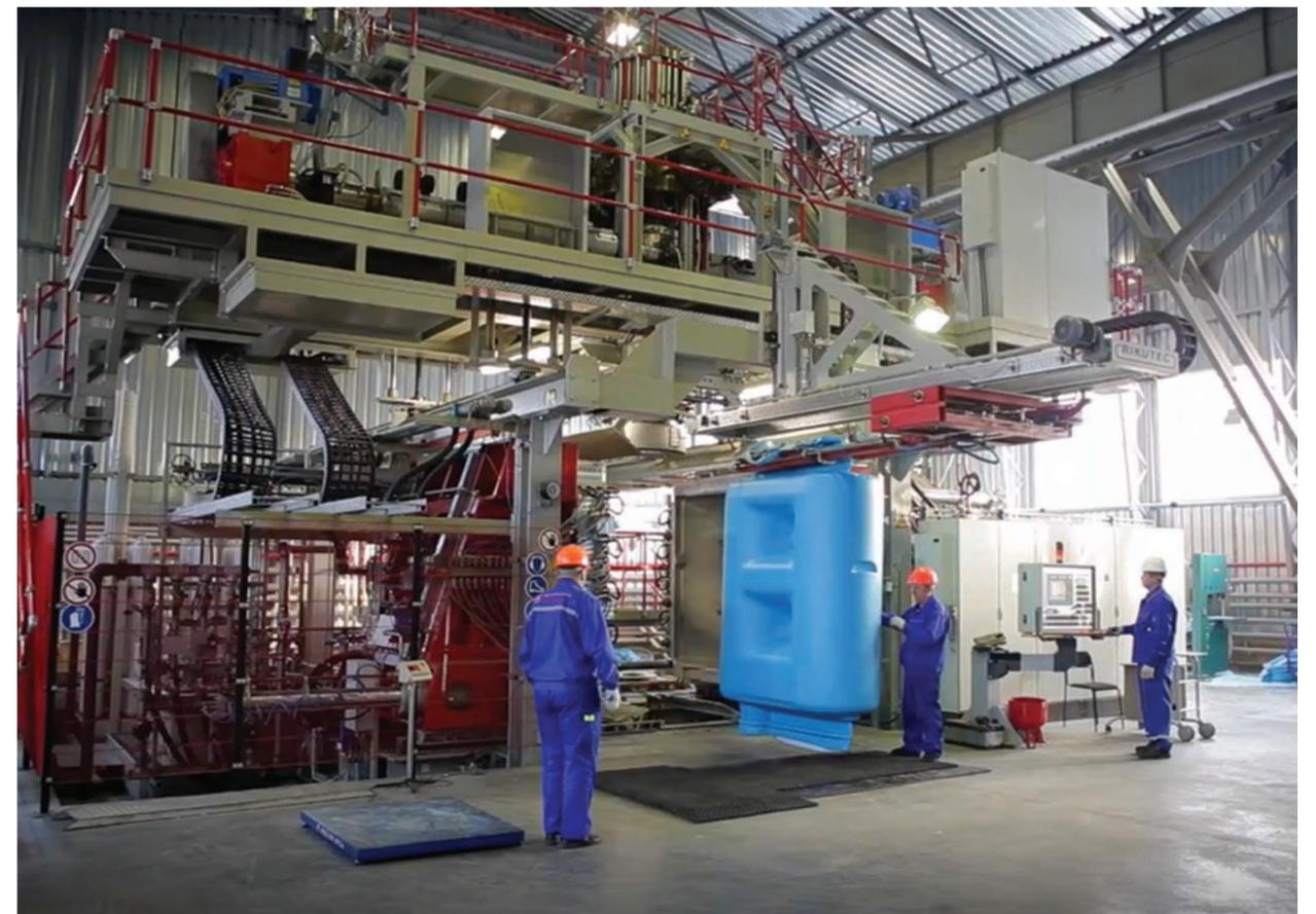
ки при постоянно вращающихся шнеках и работе нагревательных элементов материал подвергается плавке. Доведенная до однородного состава и нужной консистенции масса поступает на экструзионную головку. В этой зоне должна поддерживаться стабильная температура и соблюдаться скорость продавливания расплава, чтобы основа будущего изделия имела поверхности заданных параметров без наплывов и брака.
