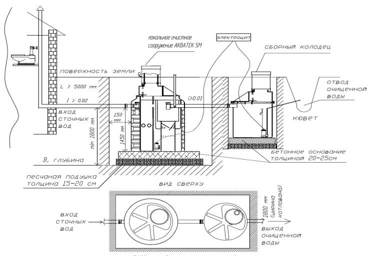
Рис. 4.2. Монтажная схема локального очистного сооружения АКВАТЕК 5М со сборным колодцем (плывун)
