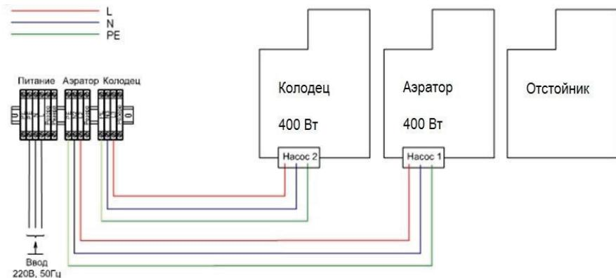
Рис. 6. Схема соединений установки локального очистного сооружения АКВАТЕК 5М
