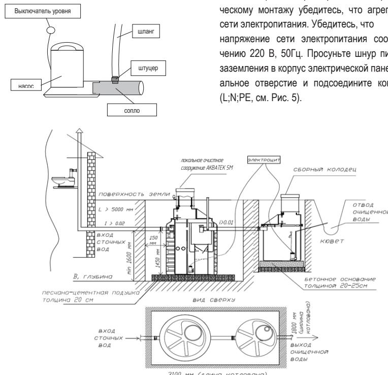
Рис. 4.1. Монтажная схема локального очистного сооружения АКВАТЕК 5М со сборным колодцем (песок, суглинок, глина)
